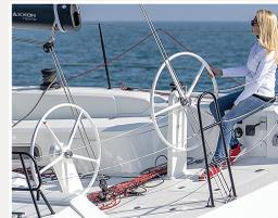
La doppia ruota è particolarmente comoda sia nella conduzione sia per garantire la migliore visibilità e per lasciare libero il passaggio centrale. L'opzione con la barra in vetroresina affascina chi ama il controllo preciso della pala del timone.
